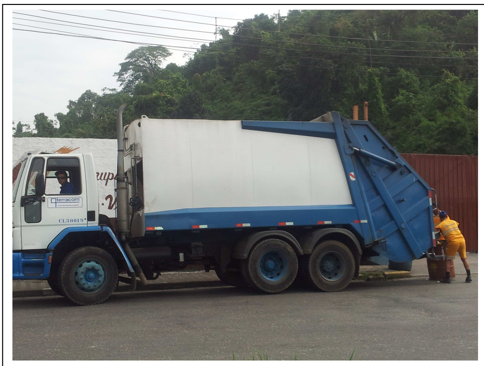
Figura 12 Caminhão compactador para coleta de resíduos domiciliares
